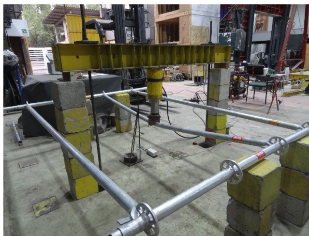
Figura 7.6.5 Estado final probeta ERB-BARANDA-01
