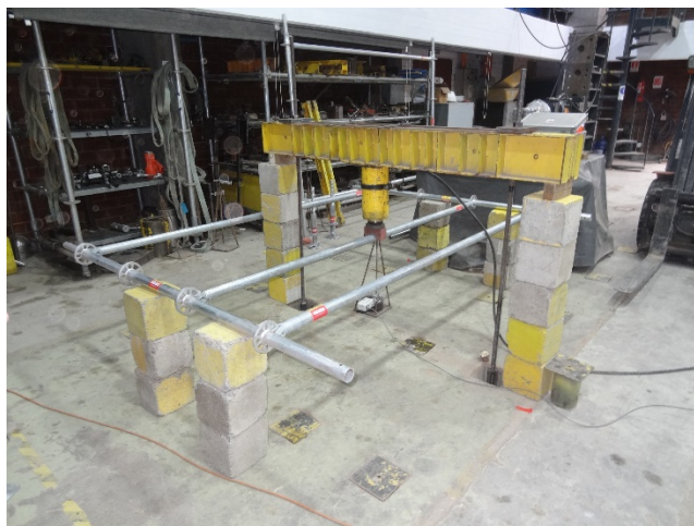
Figura 7.6.2 Montaje del ensayo a Baranda
