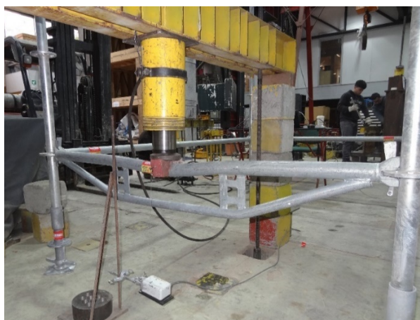
Figura 7.3.9 Estado final probeta EFTr-TRAVESAÑO2-01
