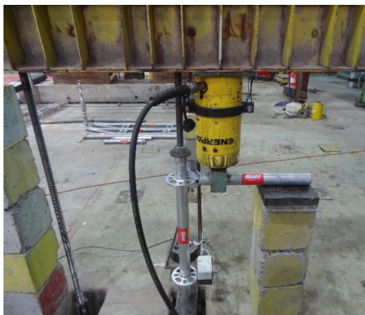
Figura 7.14.2 Montaje del ensayo de Corte de conexión.
