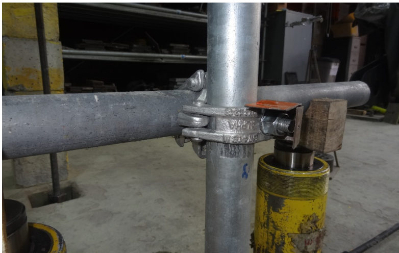
Figura 7.19.6 Estado final probeta ERA-ABRAZADERA-01
