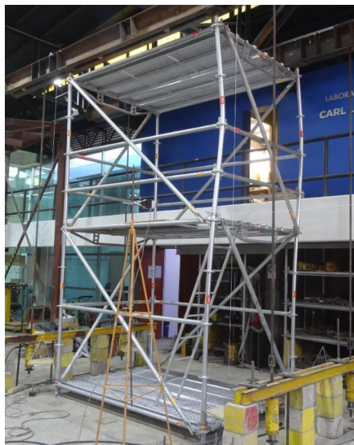
Figura 7.9.7 Estado Final Probeta ERT-TORRE-02
