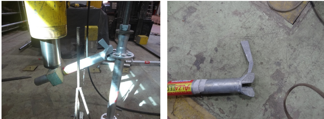
Figura 7.15.5 Estado final probeta EFC-CONEXIÓN-02
