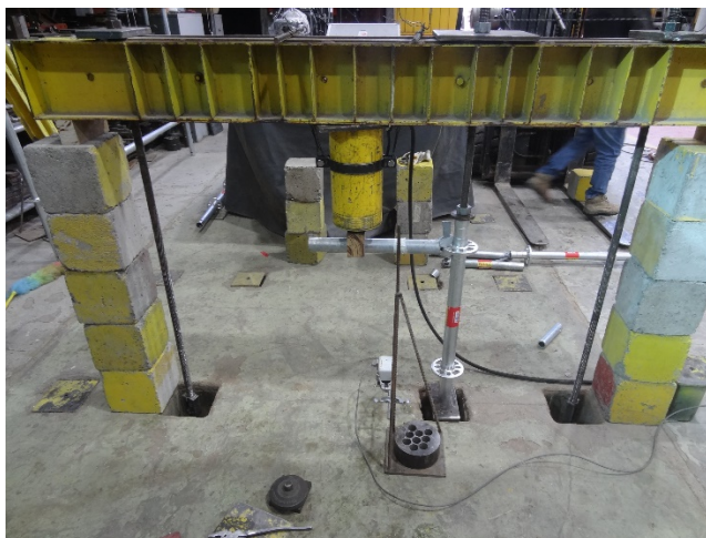
Figura 7.15.2 Montaje del ensayo a flexión de conexión.
