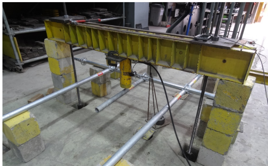
Figura 7.16.2 Montaje del ensayo a flexión de conexión.
