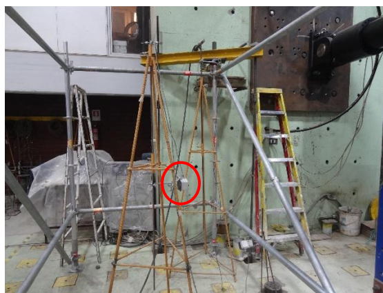
Figura 7.7.3 Probeta ensayo vista posterior – sensores pandeo.
