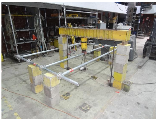
Figura 7.6.2 Montaje del ensayo a Baranda
