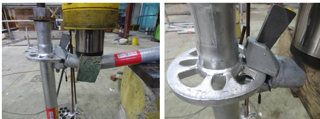
Figura 7.14.5 Estado Final probeta ECC-CONEXIÓN-02
