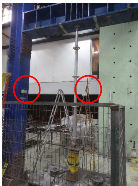
Figura 7.4.3 Montaje Sensores para pandeo
