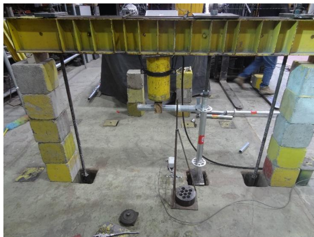
Figura 7.15.2 Montaje del ensayo a flexión de conexión.
