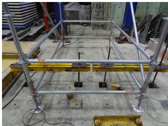
Figura 7.18.3 Anclaje para evitar levantamiento
