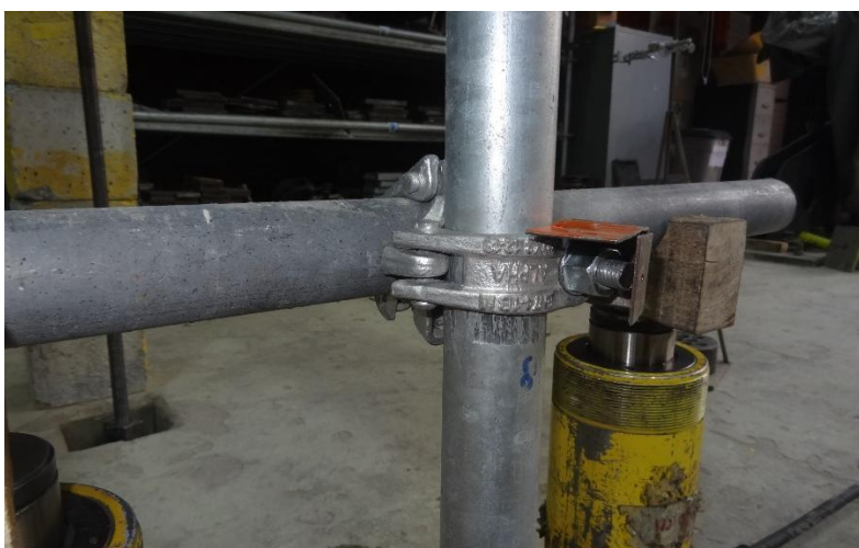
Figura 7.19.6 Estado final probeta ERA-ABRAZADERA-01
