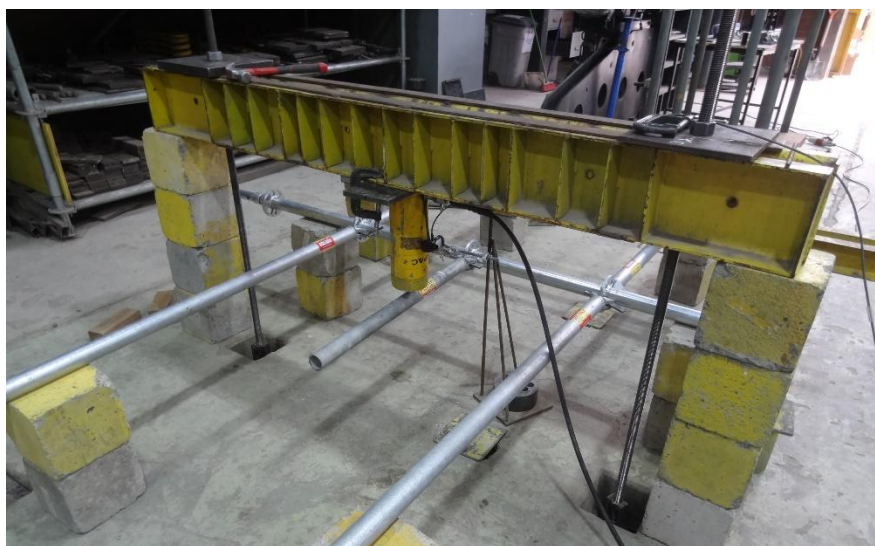
Figura 7.16.2 Montaje del ensayo a flexión de conexión.
