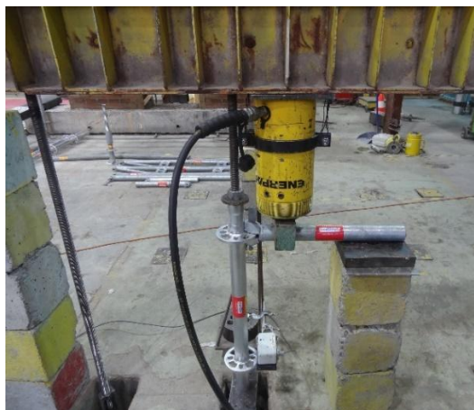
Figura 7.14.2 Montaje del ensayo de Corte de conexión.
