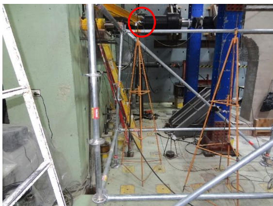
Figura 7.7.2 Montaje del ensayo vista lateral – sensor lateral.
